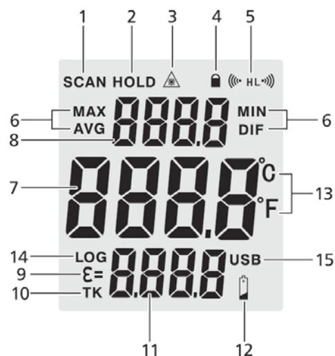
11. Leitura de temperatura por termopar e valor de emissividade.
